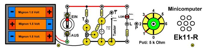
Alles wird in einen **Kasten** eingebaut, der auch die 26 **Steckschuhlitzen** für die Kombination der verschiedenen Baugruppen enthält. Die Elektronik-Bauteile werden mit **Reißnägeln** auf eine **Sperrholzplatte** mit Deckblatt aufgebaut, auf dem die genaue Platzierung der Bauteile erkennbar ist. Um **Überkreuzungen** der Anschlussdrähte zu **vermeiden**, liegen etwa ein **Drittel** der **Bauteile** auf der **Rückseite** der Platte.
