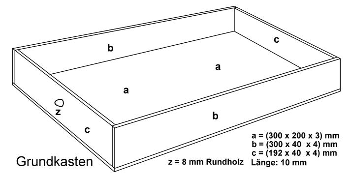
21. Leime für den Kasten die Seitenleisten (b und c) auf die Bodenplatte a. Die Leisten müssen "ohne Luft" fest auf die Bodenplatte und auch an den Ecken geleimt werden (kleine Schraubzwingen). Wir haben auch gute Erfahrungen mit einem auf die Bodenplatte gelegten großen Ziegelstein (3 DF, mit Griffloch) gemacht (Kasten umdrehen), der auch genügend Druck erzeugt. Der Leim muss einen Tag lang trocknen.
