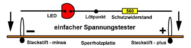
Baue dafür einen einfachen **Spannungstester**, indem du eine Leuchtdiode mit einem Schutzwiderstand 560 Ohm zusammenlötest.
