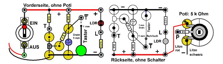
15. Alle Zählbausteine sind gleich aufgebaut. Löte zuerst die Widerstände 10 k Ohm (R5 und R6) über der Deckplatte an die Reißnägel 1; 2; 5 und 6 (weiße Kästchen). Dann folgen die Kondensatoren 2,2 uF auf die Reißnägel 5; 6, 7 (Polarität beachten: Minuspol oben an 7). Die Diode D1 liegt über der Deckplatte (weiß), die Diode D2 unten (weiß).
