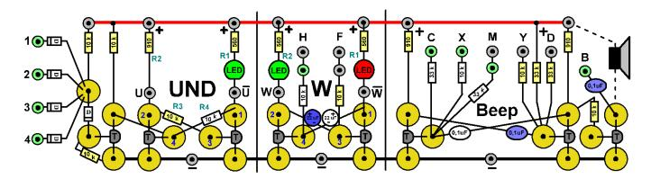
In der zweiten Reihe liegen ein **UND- Gatter** (auch als ODER- Gatter zu schalten), ein **Wechselblinker** und ein **Beeper** mit Lautsprecher. In der dritten Reihe liegen das **Batteriekästchen** der **Schalter**, der **Taster** und die beiden analogen Baugruppen **LDR** und **Potentiometer**.
