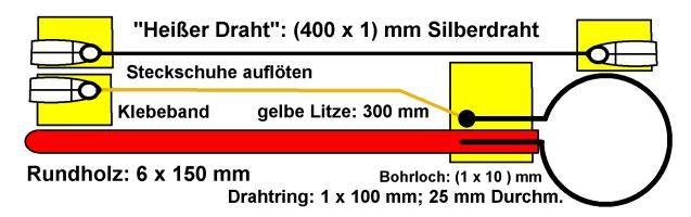
20. Löte für den "heißen Draht" Steckschuhe an die Enden eines versilberten Kupferdrahtes (400 x 1) mm und lege Klebeband um die Steckschuhe (Berührungsschutz). Befestige einen Drahtring an einem Rundholz und löte eine Litze mit Steckschuh daran. Umwickele den Steckschuh und auch die Ringlötstelle mit Klebeband (Knickschutz).
