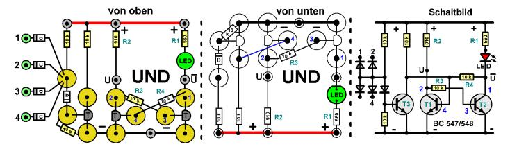
**Test 9:** Schalte die Spannung ein: Die grüne LED des UND-Gatters leuchtet. Lege die Steckstifte (1; 2; 3 und 4) nacheinander an die Minusleitung: Die LED erlischt (reset). Plusspannungen an den Eingängen sind ohne Wirkung. Das UND-Gatter wird durch **Nullspannung** zurückgesetzt.
