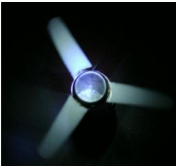
**Bild 21:** 3 Blitze bei 4 Umdrehungen Frequenz - 75 Hertz
