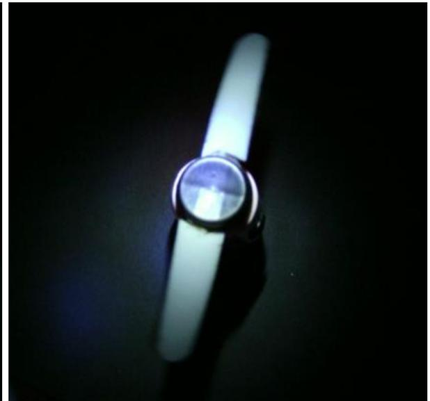
**Bild 20:** Das Str15 blitzt 2 Mal bei 3 Umdrehungen der Flügel: Frequenz –  $66 \frac{2}{3}$  Hertz.
